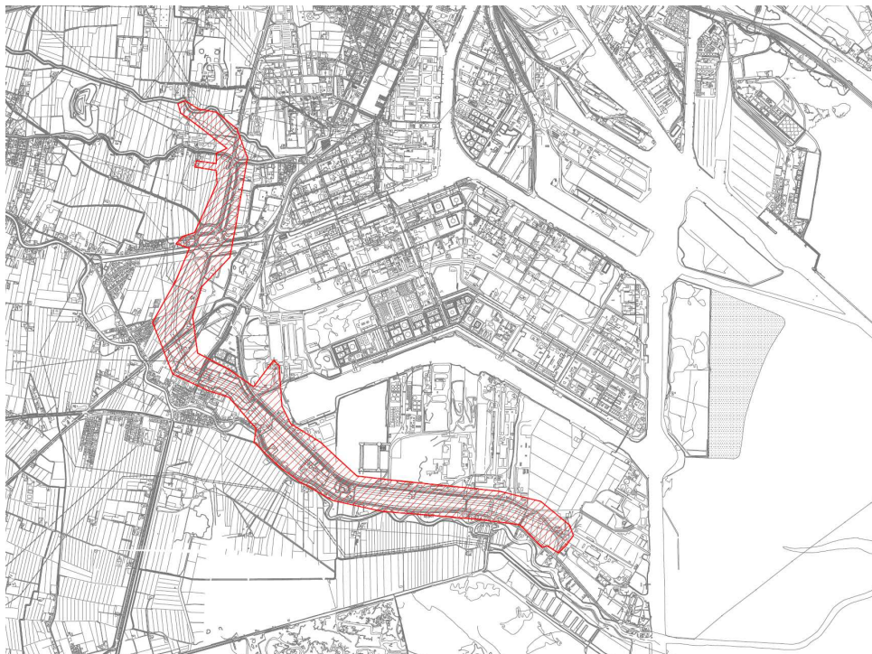
Figura 4-1 Aree interessate dagli interventi sulle linee elettriche
