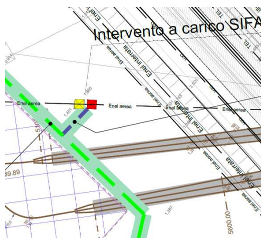
Figura 5-8 Posizione traliccio provvisorio (in rosso) e traliccio esistente da demolire (in giallo) da realizzare nell'area ad ovest della SS. 309 Romea, all'atezza di Leroy Merlin.
