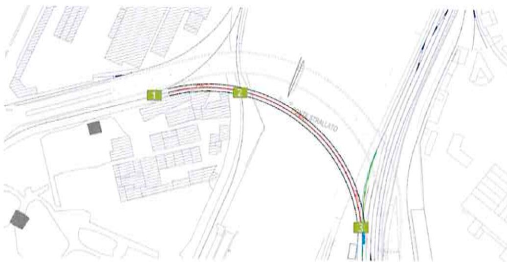
Figura 4: Connessioni e intersezioni con i binari esistenti
