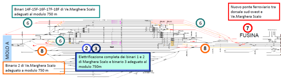
Figura 5 Interventi previsti sull'impianto di Venezia Marghera Scalo.
