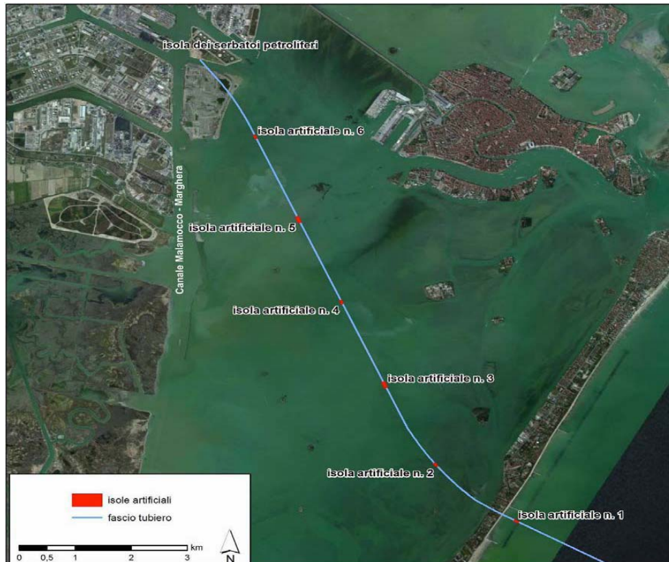
Fig.34: il percorso delle pipelines in Laguna e le isole artificiali provvisorie previste Fonte: Consorzio Venezia Nuova
