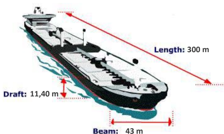
Fig.26: misure indicative della nave di riferimento
